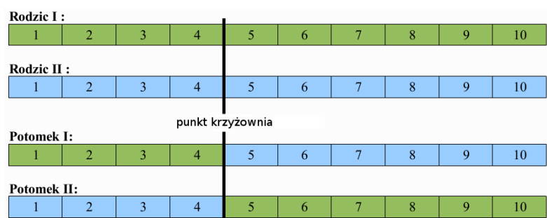
Rys. 5.6: Przykład krzyżowania jednopunktowego.
